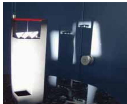
Abb. 2: Versuche: Direkte Sonneneinstrahlung (links); Sonnenlicht mit einem Spiegel (Mitte) und mit zwei Spiegeln (rechts) durch einen dunklen Raum gelenkt. Treibt das umgelenkte Sonnenlicht die Sonnenwindturbine ebenfalls an?
