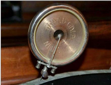
Beim Grammophon gleitet eine Nadel in einer spiralförmigen Rille. Die Rille hat kleinste Unebenheiten. Diese Unebenheiten versetzen die Nadel in Bewegung. Die Bewegungen der Nadel werden auf eine grössere Fläche übertragen. Im Bild ist das die runde Scheibe. Die Scheibe hat die Funktion einer Membrane. Die Membrane versetzt die umgebende Luft in Bewegung.
