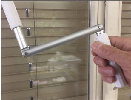
Z.B: Bei der Store siehst du eine Lösung: Auf dem Bild siehst du, wie man eine weisse Kunststoffhülle in der Hand hält. Sie ist befestigt, ist aber drehbar mit der Kurbel verbunden.
