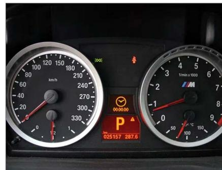
Bei Autos mit einem Verbrennungsmotor findet man eine "rpm" - Anzeige. "rpm" ist die Abkürzung des englischen Begriffs "revolutions per minute", was "Umdrehungen pro Minute" meint.
