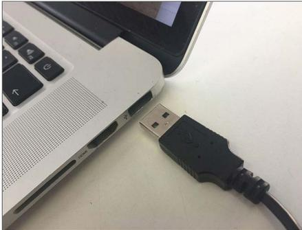
Z.B: Bei den USB-Anschlüssen besteht die Kupplung aus einer Buchse am Computer und einem Stecker am Stromumwandler (z.B. Fotoapparat).
