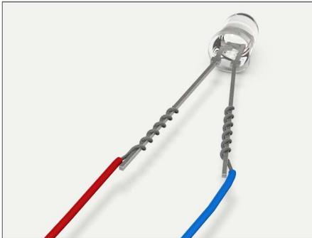
Die Kabel des Kurbelkraftwerks bestehen aus feinen Drähten, die von einer farbigen Isolation aus Kunststoff umgeben sind. Nur wenn die feinen Drähte der abisolierten Kabelenden die Beine der LED berühren, kann Strom fließen.
