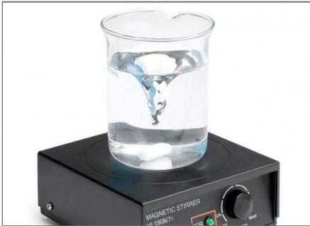
Für Chemiker ist diese Art von Mischer ein alltägliches Werkzeug: Ein rotierender Magnet bringt einen magnetischen "Fisch" in einem Glas mit Flüssigkeiten zum Rotieren, der diese Flüssigkeit gleichmässig durchmischt.
